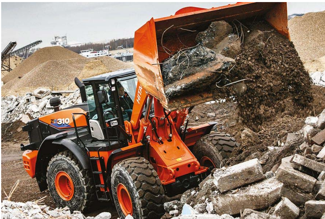
große Radlader , Schaufelgröße 3 bis 4,7 cbm ,
