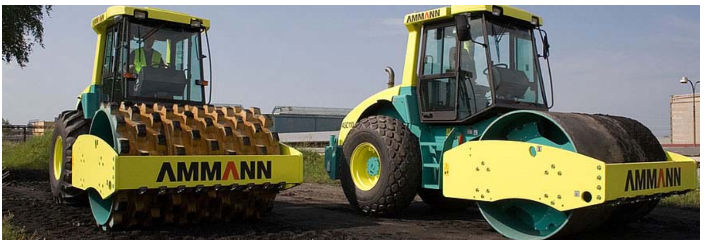
Walzenzüge mit Glattmantel- und Schafffußbandage
