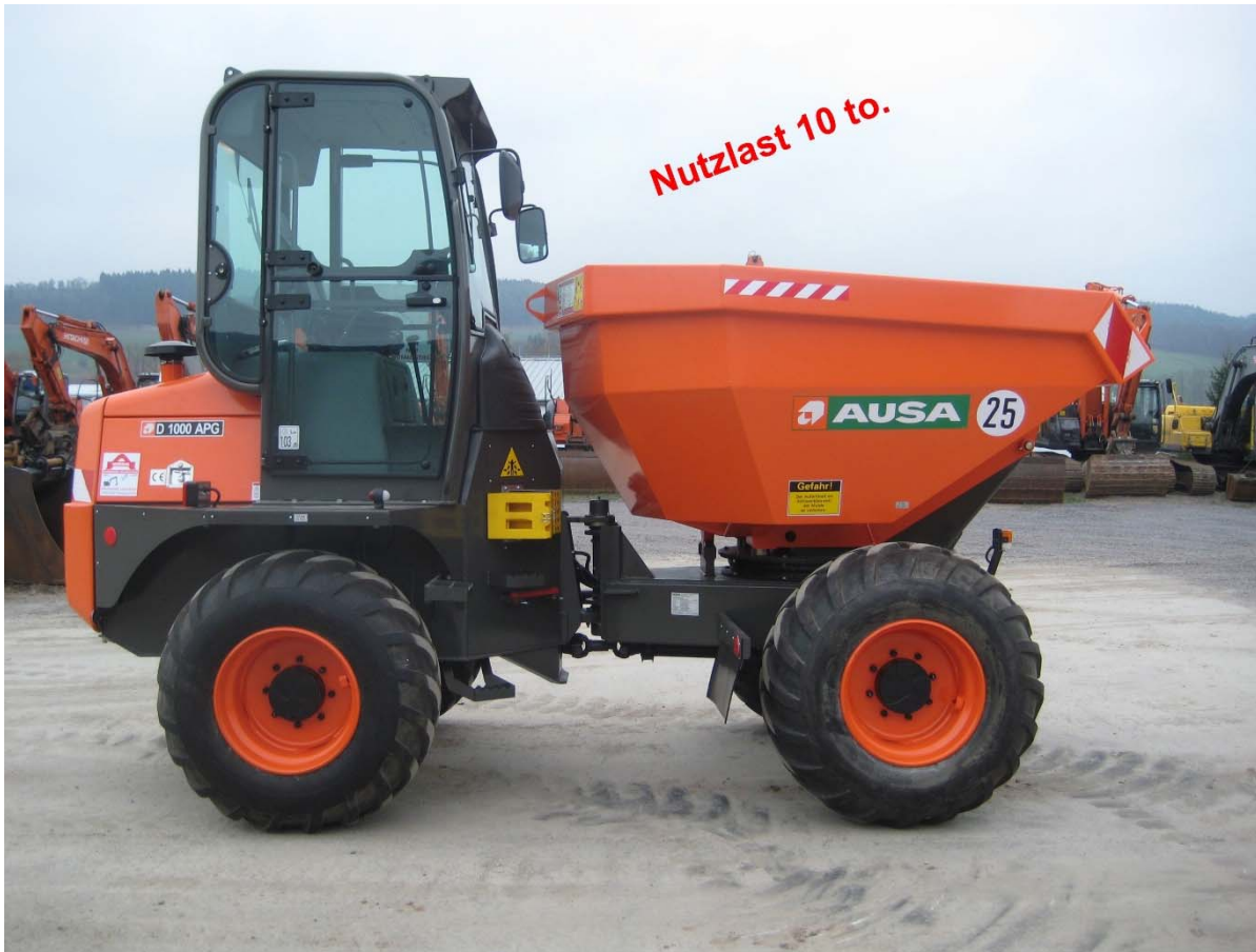
Dumper mit Kabine und einer Nutzlast von 10 Tonnen
