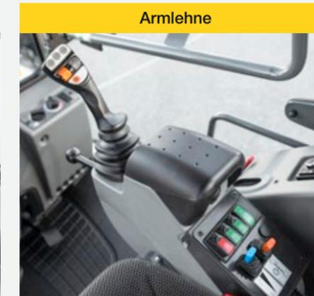
Die Armlehne und der intuitiv bedienbare Joystick sind mit den wichtigsten Bedienelementen ausgestattet. Damit hat der Fahrer alle relevanten Funktions- und Überwachungsinstrumente stets im Blick. Durch den hydraulisch vorgesteuerten Joystick ist ein feinfühliges und präzises Steuern der Maschine möglich. Die Armlehne ist hochklappbar und ermöglicht somit einen komfortablen Ausstieg nach rechts.
