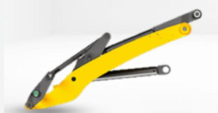
Die parallel geführte Ladeanlage gewährleistet konstante Hubkraft und eine sichere Bedienung im Materialumschlag. Durch den mit 50° hohen Rückkippwinkel und den Auskippwinkel von 45° verliert der Radlader im Schaufeleinsatz auch bei hohem Füllgrad kein Material und ermöglicht gleichzeitig ein vollständiges Entleeren der Schaufel.
