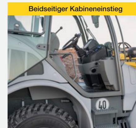
Die Fahrerkabine ist über die beidseitig, großzügig gestalteten Einstiegsbereiche zu erreichen. Die rechte Kabinentür ist somit vollwertig nutzbar. Dadurch wird dem Fahrer ein sicheres Ein- und Aussteigen auf der verkehrsabgewandten Seite ermöglicht. Auch eine Innenraumbeleuchtung mit Türkontaktschalter ist vorhanden.
