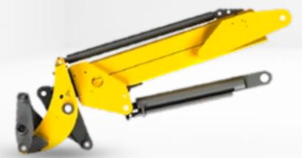
Durch die kompakte Kastenbauweise der Teleskopladeanlage ist die Sicht auf das Anbaugerät einzigartig. Der Vorteil der Z-Kinematik: Beim Einkippen der Schaufel wird bei gleicher Zylindergröße eine höhere Reißkraft erzeugt, da die Kolbenseite des Hydraulikzylinders beim Einkippen beaufschlagt wird.
