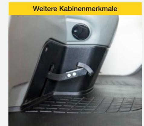
Die hängenden Pedale mit dem kombinierten Brems-Inch Pedal ermöglichen ein feinfühliges Rangieren auch bei hoher Motordrehzahl. Das höhen- und neigungsverstellbare Lenkrad bietet dem Fahrer einen tollen Fahrkomfort. Die leistungsstarke Heizung mit Scheibenbelüftung und Heizdüsen im Fußraum sorgen für angenehmes Arbeiten auch an kalten Tagen. Optional ist eine vollintegrierte Klimaanlage erhältlich.
