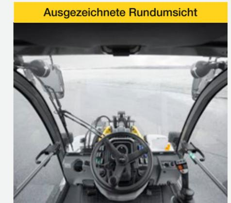
Die zentrale Sitzposition in Verbindung mit den großen Glasflächen bieten eine 360°-Rundumsicht. Die besonders übersichtliche Bauweise und die Sitzposition des Fahrers vermeiden „tote Winkel“. Auch nach hinten ist alles einsehbar. Die hochgezogene Frontscheibe erlaubt auch bei ausgefahrter Teleskopanlage noch eine perfekte Sicht auf das Anbaugerät.
