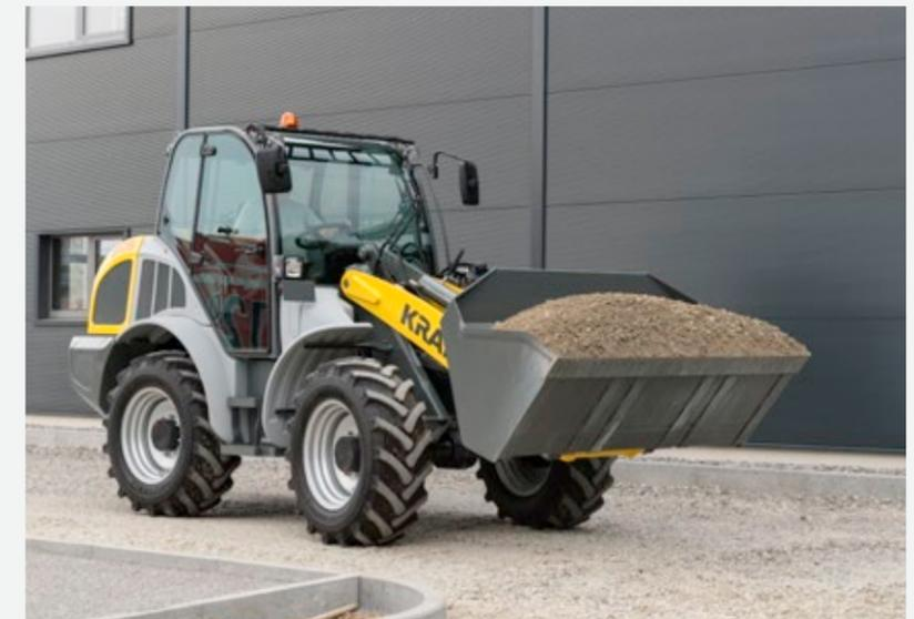
Vorderachslenkung für erhöhte Sicherheit bei schnellen Transportfahrten
