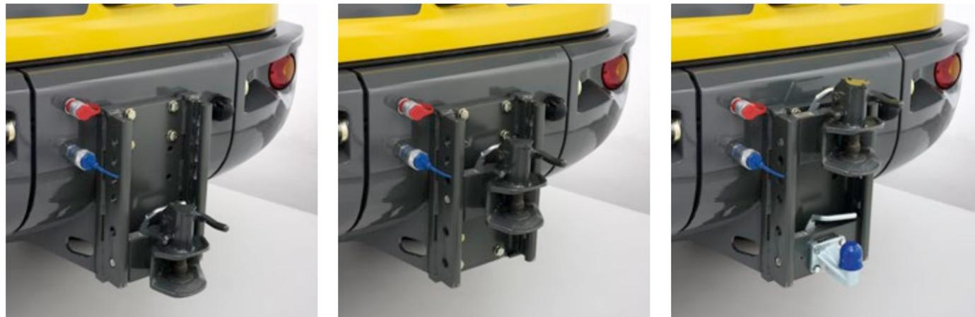
**Optimal für unterschiedlichste Einsätze:** Die Höhe der Anhängerkupplung kann flexibel angepasst werden.
